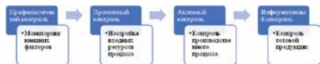
Рис. 1. Четыре уровня управления качеством на производстве (O'Regan, Prickett, Setchi et al., 2017)
